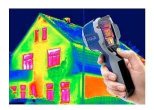
Dans un contexte de crise énergétique et d'augmentation du coût des énergies, le chauffage dans l'habitat reste un enjeu crucial. Pour réduire sa facture, les travaux d'amélioration thermique (isolation, menuiseries performantes) est une étape fondamentale. L'utilisation d'une caméra thermique permet de visualiser et de détecter certains défauts d'isolation et ponts thermiques.
